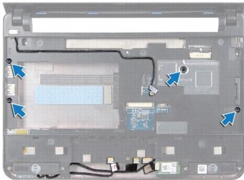
9. 電源ボタンケーブル、Bluetooth カードケーブル、電源 / バッテリステータスライトケーブルおよび、スピーカケーブルを、それぞれのシステム基板コネクタから外します。
